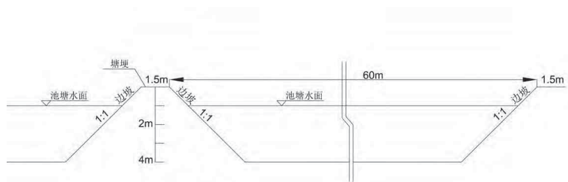
图 5.3-3 鱼塘典型设计剖面示意图
