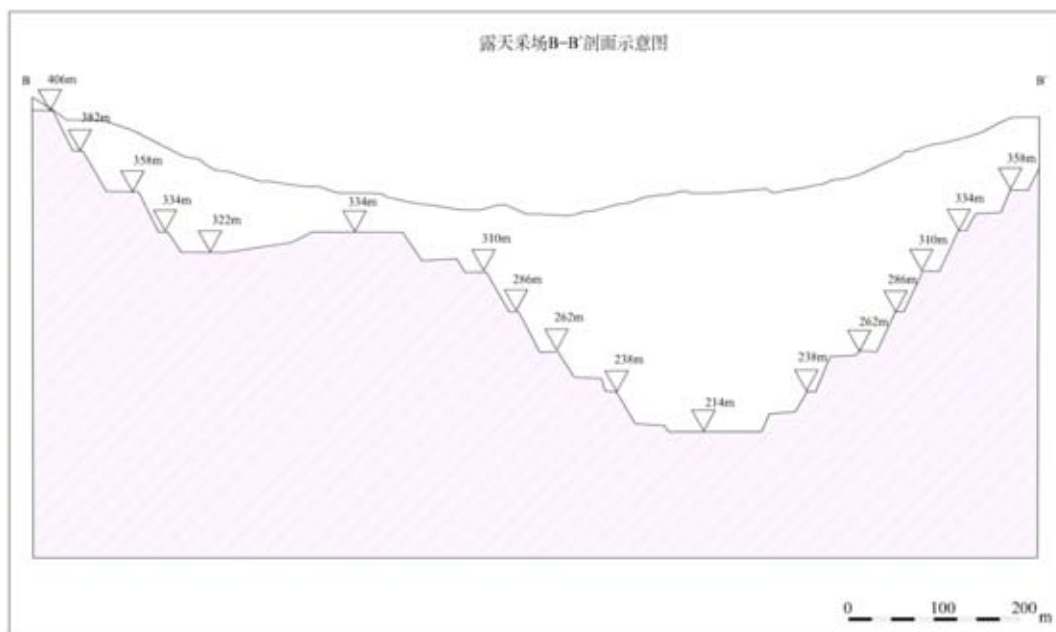
图1-8 翁泉沟硼铁矿主露天采场终了B-B' 剖面示意图
