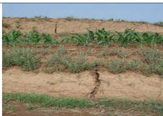
照片 3-2-12 S2205 工作面地裂缝 L8
