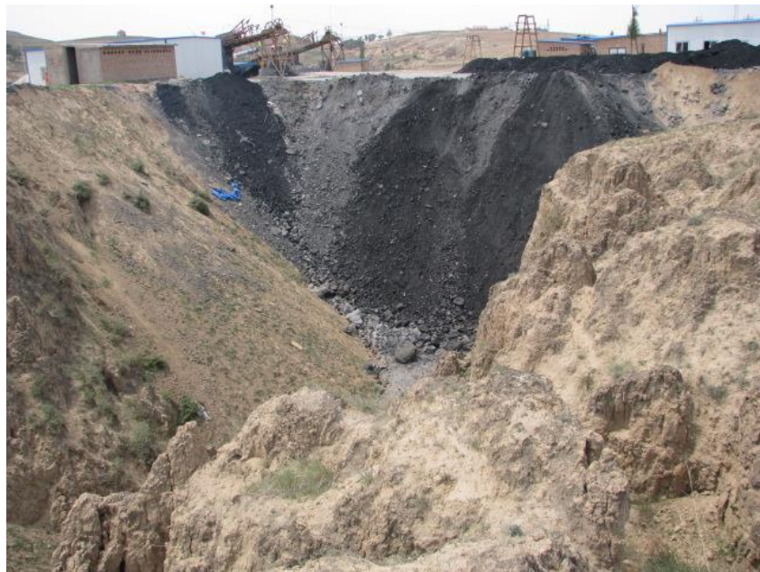
照片 1-2 排矸场沟底排矸场形态
