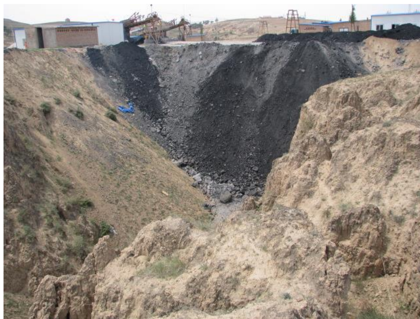
照片 3-7 排矸场沟底排矸场形态
