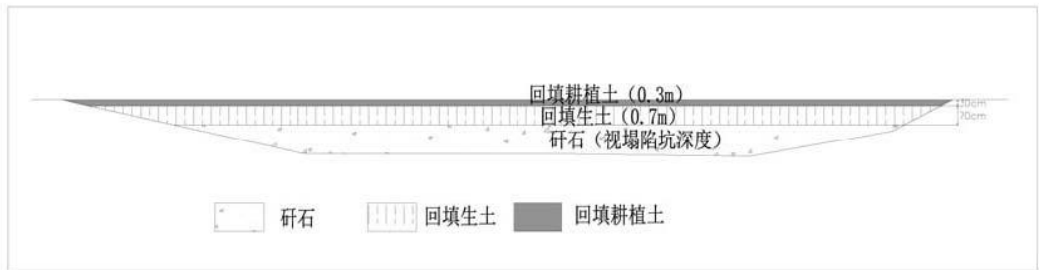
图 5.2-1 塌陷坑回填示意图
