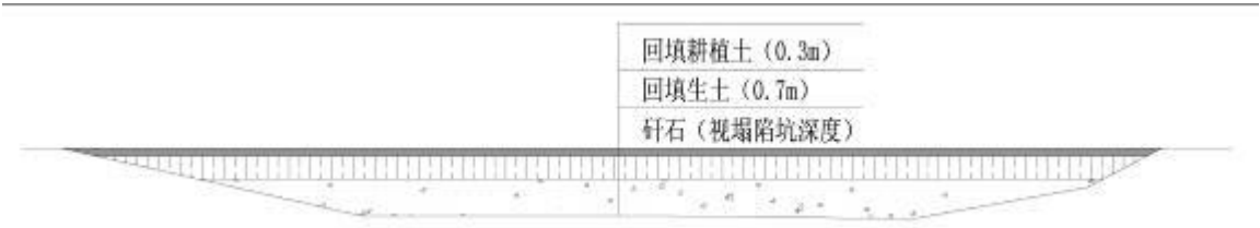
图 5.3-1 塌陷坑回填示意图
